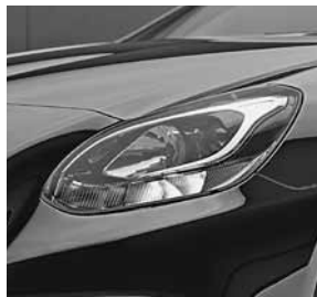
Faros principales en técnica de proyección H7 con luces diurnas integradas
